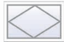
M3 Einlage Rhombus (erhaben, innenliegend) F49 B490xH325mm
