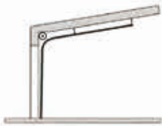
Normalbeschlag mit Dachfolge Sturzbedarf 290mm, Seitenanschlag 90mm (Alu 110mm)
