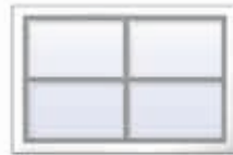
M2 Einlage Kreuz (erhaben, außenliegend) F49 B490xH325mm F65 B650xH325mm
