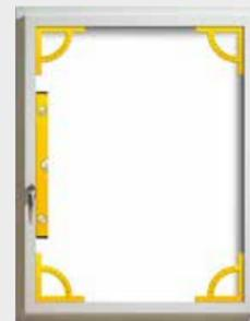
Der verschweißte Flügelrahmen wird winkelig gespannt.
