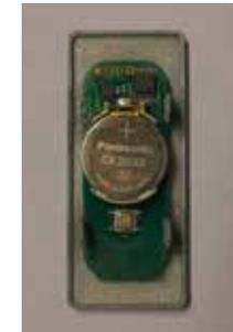
Batterie aus dem Bedienteil entnehmen,
