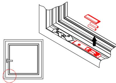
Batterien wieder einlegen. Auf richtige Polarität achten! Batterieabdeckung wieder aufsetzen. Der Anlernvorgang kann nun abgeschlossen werden.
