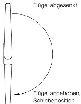
Griff nach unten drehen, Flügel wird angehoben:
