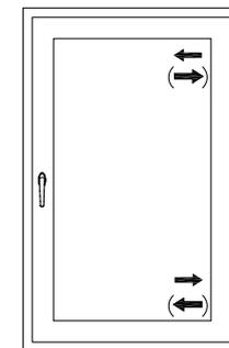
Wird der Verstellweg an den Bandteilen in entgegengesetzter Richtung ausgeführt, so führt dies zu einem Anheben oder Absenken des Flügels auf der Getriebeseite.
