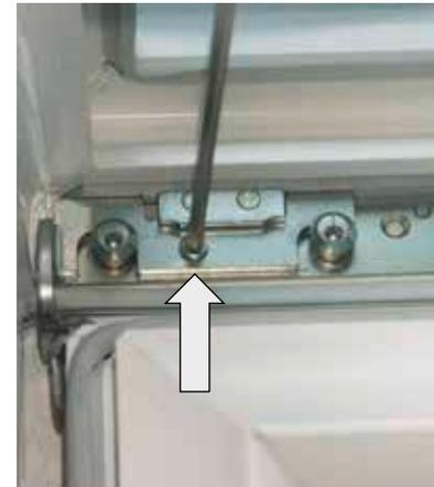
Fixierschraube am Kipplager mit Inbusschlüssel SW4 lösen.
