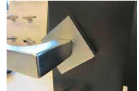
Drückerrosette wird auf die Unterkonstruktion aufgeschraubt. Klemmfunktion erfolgt über einen O-Ring. Ein Bund mit 0.4mm Höhe verhindert das Zerkratzen der Oberfläche beim Drehen der Rosette. (sichtbarer Spalt nach dem Festziehen). Die Schleifrichtung der Rosette kann nach der Montage variieren.
