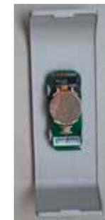
Alte Batterie entnehmen, Neue einsetzen
