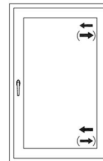
Wird der Verstellweg an den Bandteilen in gleicher Richtung ausgeführt, so kann der Flügel in horizontaler Richtung justiert werden.
