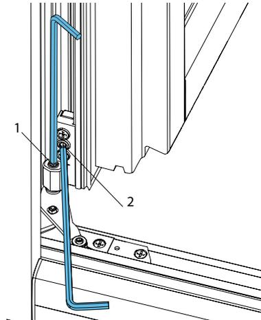
Anpressdruckverstellung mit Gabel-
