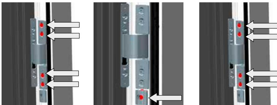
1. Bei allen Bändern die Senkkopfschrauben (Pfeile) am Rahmen leicht lösen.
