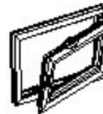
Wird bei geöffnetem Flügel der Fenstergriff in Kippstellung gebracht, so löst sich der Flügel aus der oberen Verriegelung. Um Verletzungen bzw. Beschädigungen zu vermeiden, gehen Sie bitte folgendermaßen vor:
