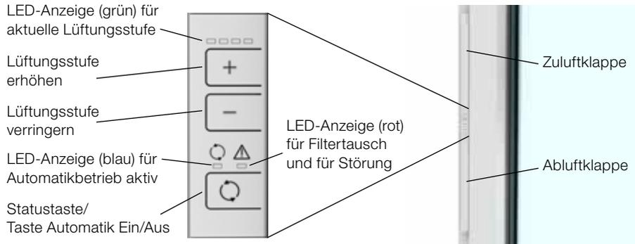
Die jeweilige Lüftungsstufe wird am Anzeigefeld mit grünen LEDs dargestellt.
