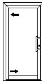
Werden alle Bänder in die gleiche Richtung verstellt, so kann hiermit die Falzluft (Abstand Schlossstulp – Schließblech) reguliert werden.
